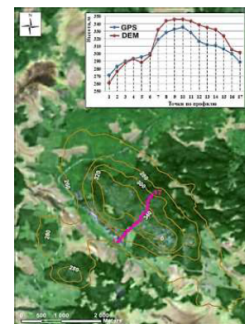
Данные GPS-замеров и значений высот на построенной ЦМР
